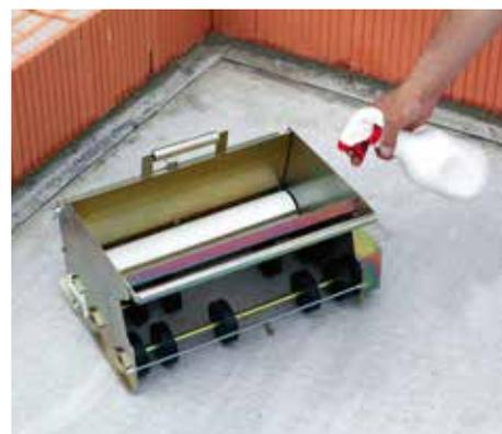
5. Die Mörtelrolle vor der ersten Befüllung dünn mit Trennmittel einsprühen. Das verhindert das Anhaften von Mörtel und erleichtert die spätere Reinigung.
